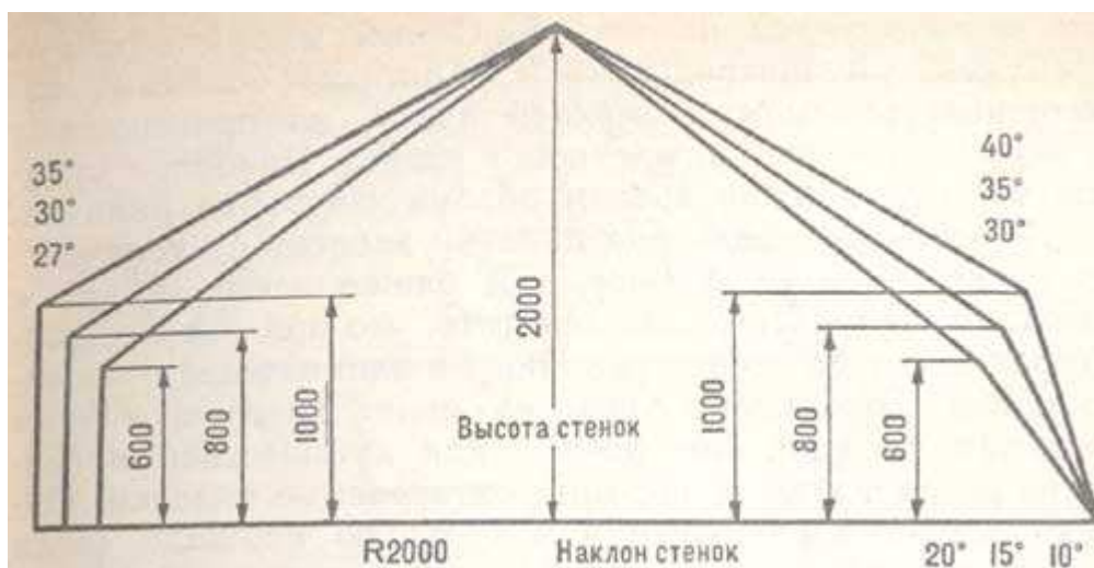
Рис. 8. Зависимость крутизны скатов от высоты и наклона стенок палаток
