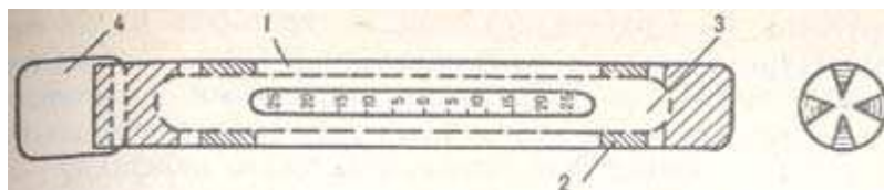
Рис. 44. Термометр: 1 — дюралевая трубочка с прорезью для шкалы; 2 — уплотнитель; 3 — пробка; 4 — петля из шнура.
