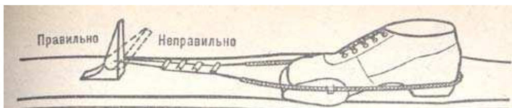
Рис. 60. Положение «лягушки» при установке креплений.
