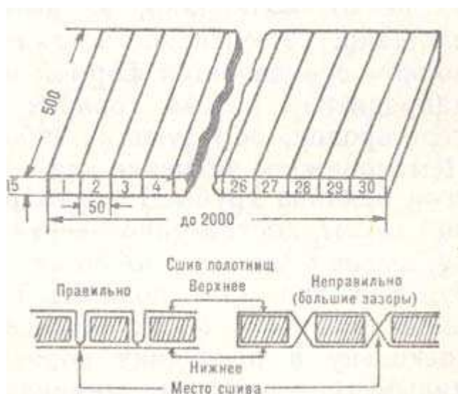
Рис. 18. Изолирующий коврик из пенопласта
